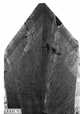
Abb. 11. Platte \parallel c von ursprünglich farblosem, „gewöhnlichen“ Bergkristall, ca. 3 cm breit. Nach \gamma -Bestrahlung erkennbar: Zonarbau nach positivem Rhomboeder (durch die Mitte des Schnittes verläuft eine etwa senkrechte Dauphiné-Zwillingsgrenze), dazu schwächer gefärbte Randzonen nach dem Prisma. Die für „gewöhnliche Quarze“ charakteristischen Kristallbaufehler sind an der fächerartigen Verzweigung der Subindividuen zu erkennen. Fundort: Druckstollen Sta. Maria-Nalps, Schweizer Alpen [60].
